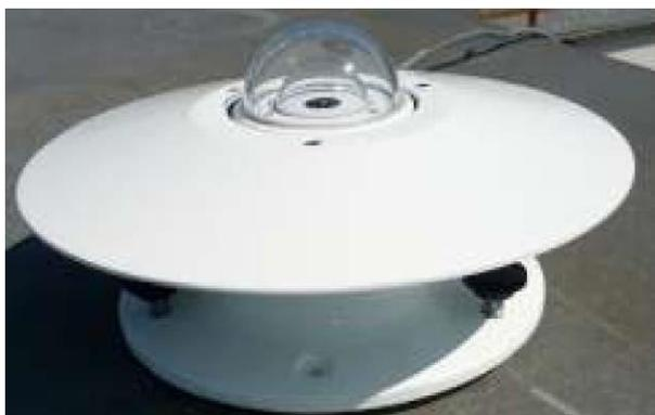
Um piranômetro é usado para medir a energia total do Sol. Quando nivelado no plano horizontal, isso é chamado de Irradiância de Onda Curta Global (GLOBAL), e quando posicionado no plano de uma série de módulos FV é chamado de Irradiância Total no Plano dos Módulos (TPA). Invertido, um piranômetro é usado para medir a Irradiância Refletida ou Albedo (ALBEDO). Um piranômetro também pode ser sombreado do raio direto do Sol para medir a Irradiância de Onda Curta Difusa (DIFUSA).
