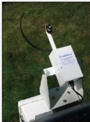
Figura 1: Unidade principal do RSR2 da Irradiance e sistema de medição do recurso solar.
