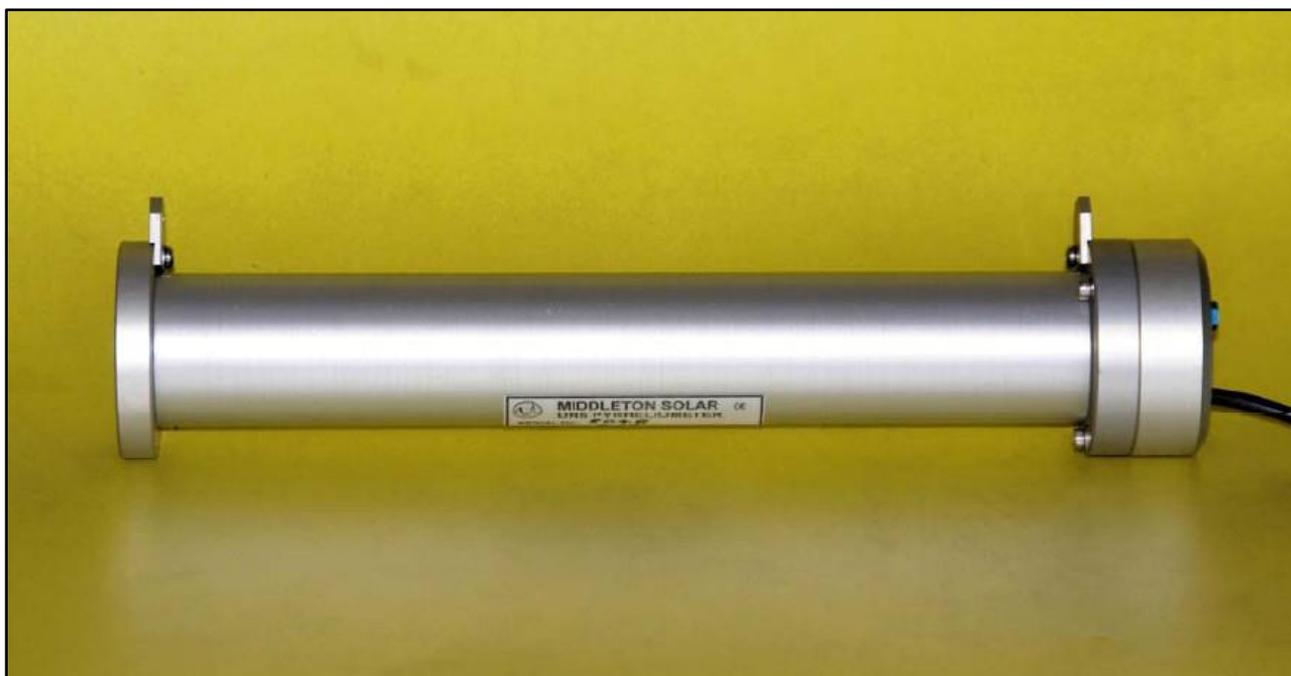
O Middleton Solar DN5 é um pireliômetro de precisão econômico para medir irradiância solar direta normal quando apontado ao Sol. Ele excede todas as especificações internacionais aceitas para um pireliômetro Primeira Classe. O DN5 tem uma saída de microvolt e a versão DN5-E tem um amplificador embutido para dar uma saída de milivolt para fácil medição do sinal.
