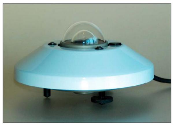
O Middleton Solar EQ08 é um piranômetro de precisão para a medição de irradiância solar global em uma superfície plana. Ele excede todas as especificações internacionais aceitas para um piranômetro de boa qualidade. O EQ08 incorpora um sensor termoelétrico de última geração. A versão EQ08-E tem um amplificador de sinal.
