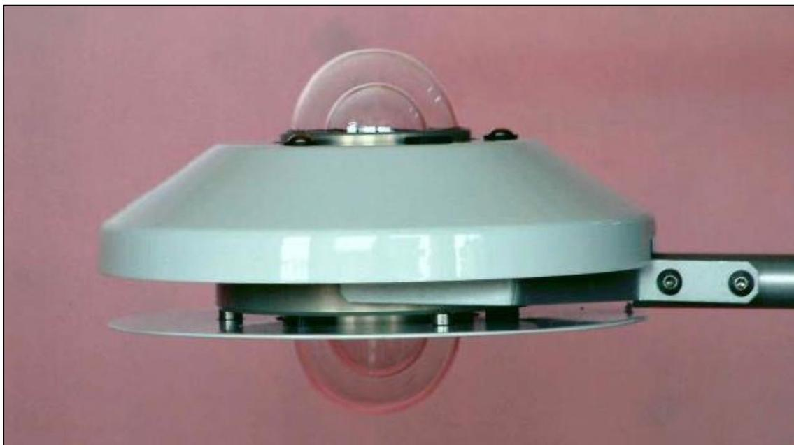
O Albedômetro EQ18-A da Middleton Solar é uma versão dupla do piranômetro Classe A EQ09-A da Middleton Solar. É desenhado para a medição do albedo, que é a relação entre o fluxo da radiação solar ascendente e descendente em um plano horizontal. O EQ18-A tem uma saída direta em microvolt e a versão EQ18-AE tem um amplificador de sinal embutido para saída em milivolt.
