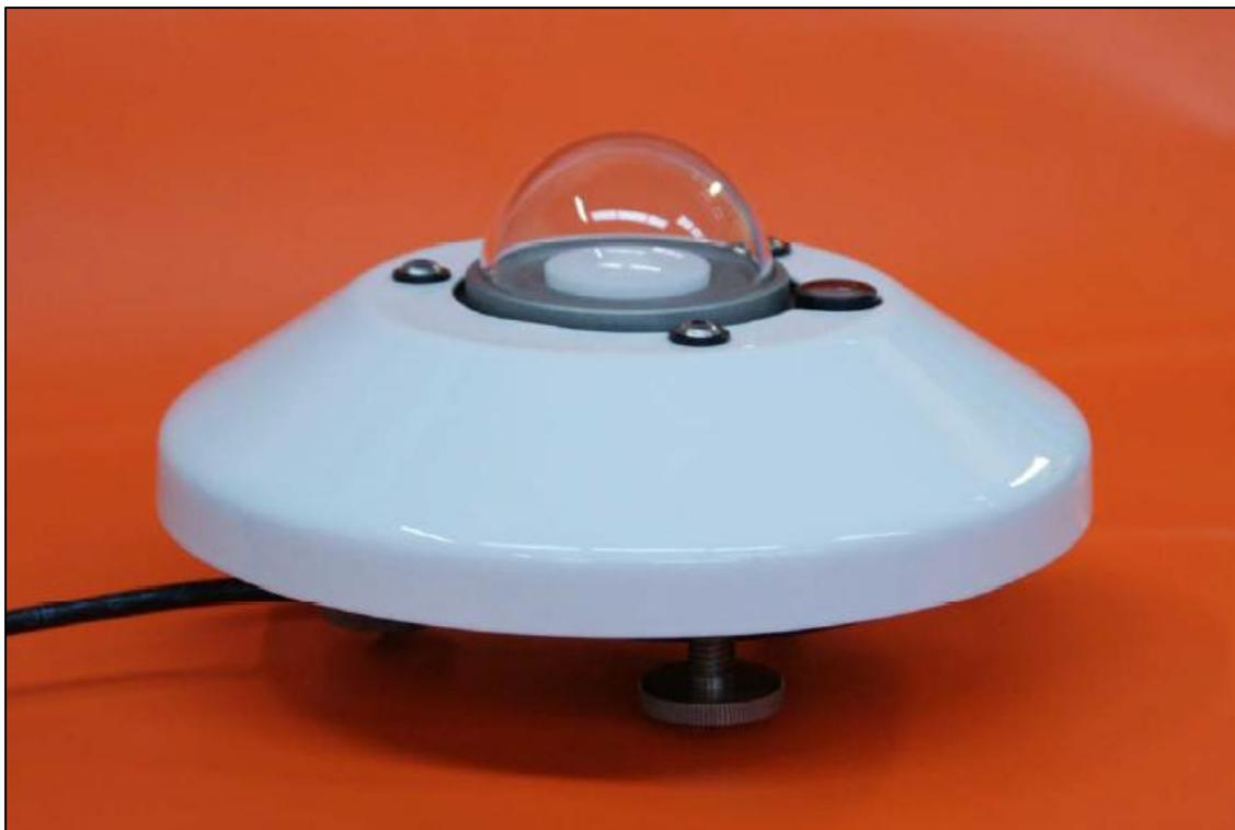
O Middleton Solar ER08-S excede as especificações ISSO 9060 para um Piranômetro de Padrão Secundário da mais alta qualidade. O ER08-S apresenta um novo desenho inovador para dar um deslocamento do zero muito baixo e termopilha de resposta rápida. A versão ER08-SE tem um amplificador integrado com uma saída de milivolt para fácil medição do sinal.
