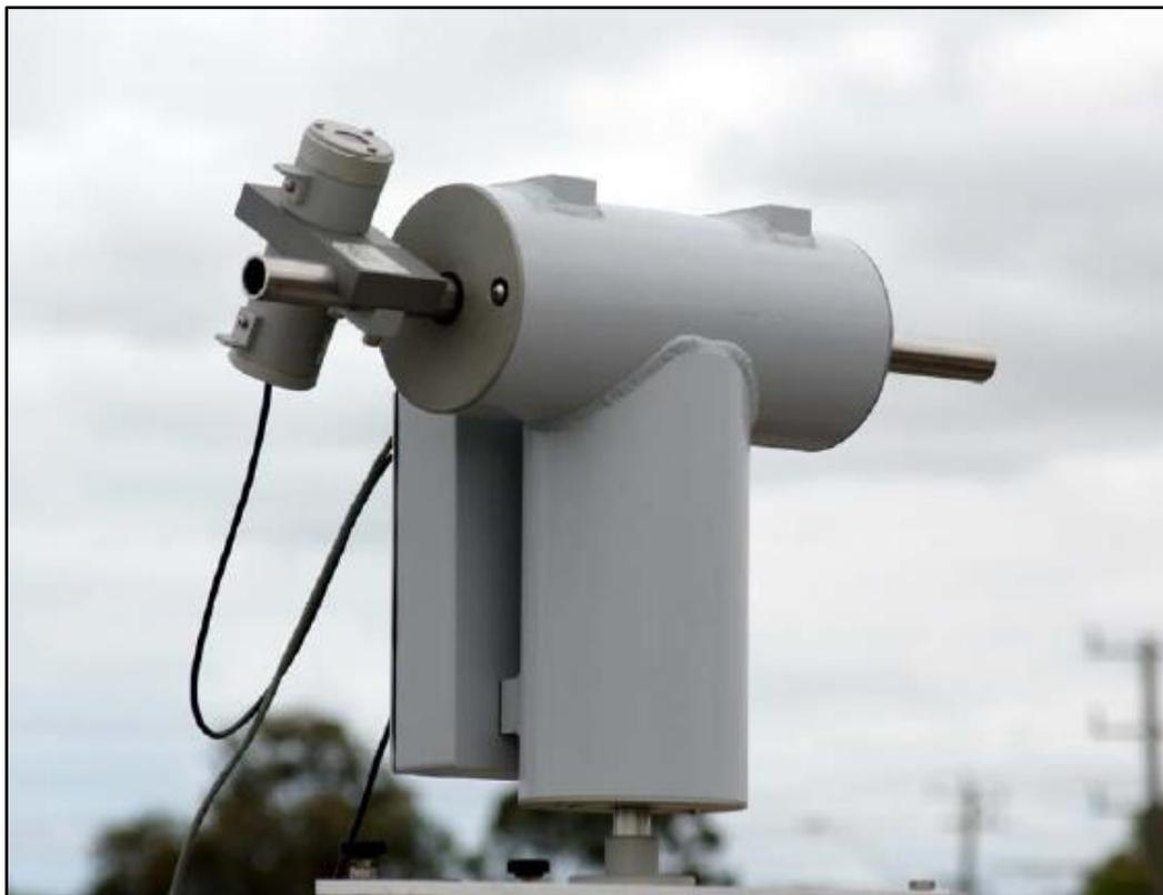
O Middleton Solar AST-02/3 é um rastreador solar ativo de 2 eixos para automaticamente apontar radiômetros ao Sol durante o dia. O AST-02 tem braço horizontal único, e o AST-03 tem um braço duplo.
