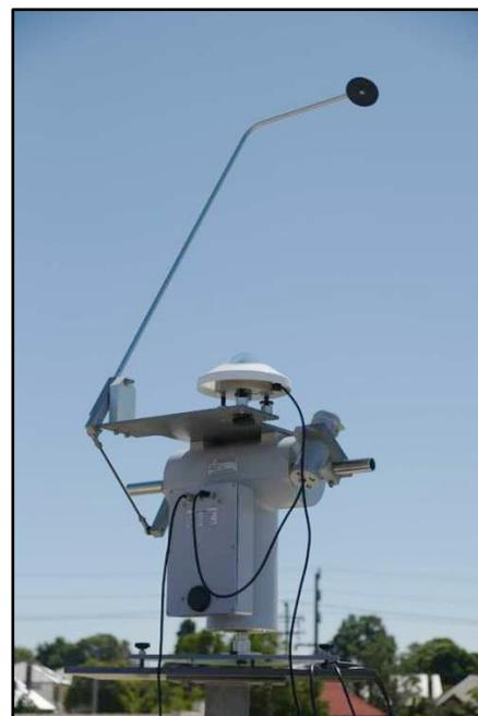
A Estação de Medição Solar Middleton Solar permite a medição integrada e simultânea de irradiância solar com precisão e exatidão. São medidos simultaneamente os valores de irradiância solar direta normal (DNI), difusa horizontal (DHI) e global horizontal (GHI).
